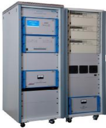
電圧出力の直流変流器 DCCTの校正
