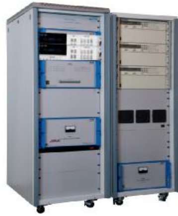
電圧・電流出力の直流変流器 DCCTの校正
